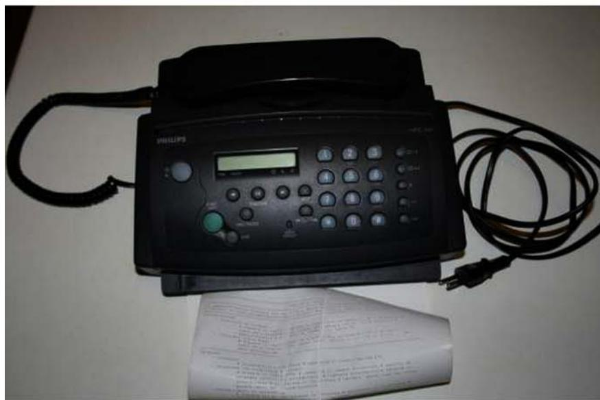
Fax používají některé firmy i v dnešní době. Princip činnosti faxu je založen na tom, že máme vytištěný dokument (nejčastěji list formátu A4). Tento dokument protáhneme přístrojem faxu, čímž dojde k jeho digitalizaci a tato data jsou pak poslána přes telefonní linku příjemci, který má jako koncové zařízení též připojen fax (zpravidla v kombinaci s telefonem). Příjemci se dokument na přístroji zpravidla automaticky vytiskne. Leckdy ale dochází ke
